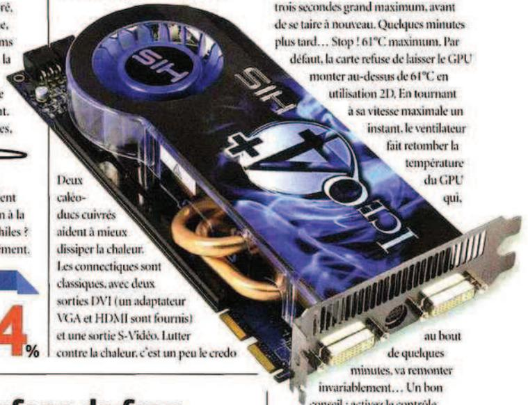
Deux calco-cuivres aident à mieux dissiper la chaleur. Les connectiques sont classiques, avec deux sorties DVI (un adaptateur VGA et HDMI sont fournis) et une sortie S-Vidéo. Lutter contre la chaleur, c'est un peu le credo
